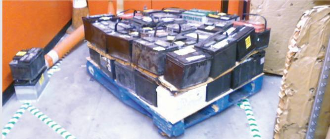
Desechos de baterías agrupadas en columnas de dos baterías sobre una paleta.
