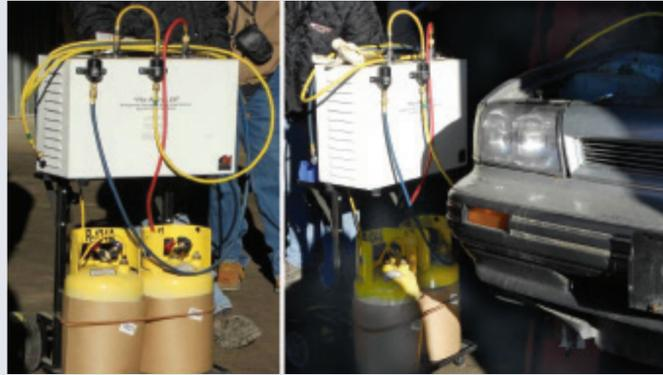
Izquierda: Bomba para remover refrigerante y tanque de contención.
